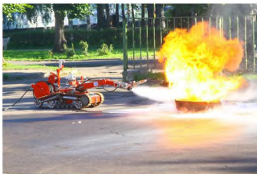
Рисунок 76. Тушение очага пожара роботом МРК-РП
