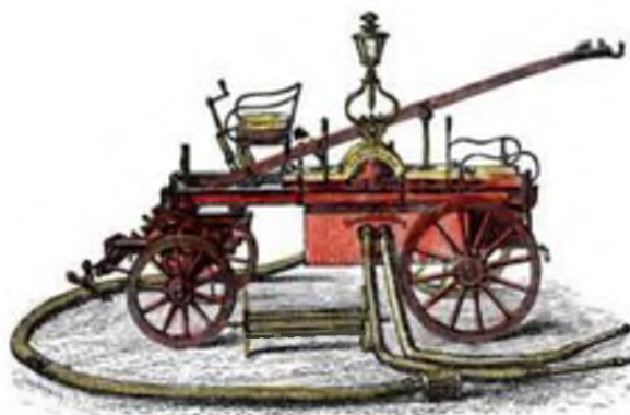
Рисунок 3. Пожарный насос с кожаными рукавами и медными брандспойтами.
